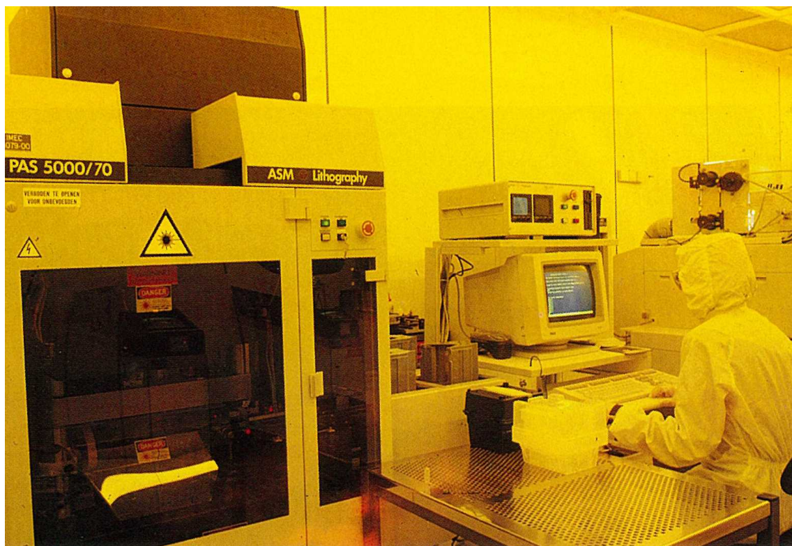
図 2 IMEC に納入された ASML の露光機 PAS5000/70 (IMEC Annual Report 1991 より)
